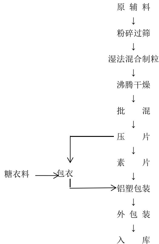
图 3-8 片剂工艺流程示意图
