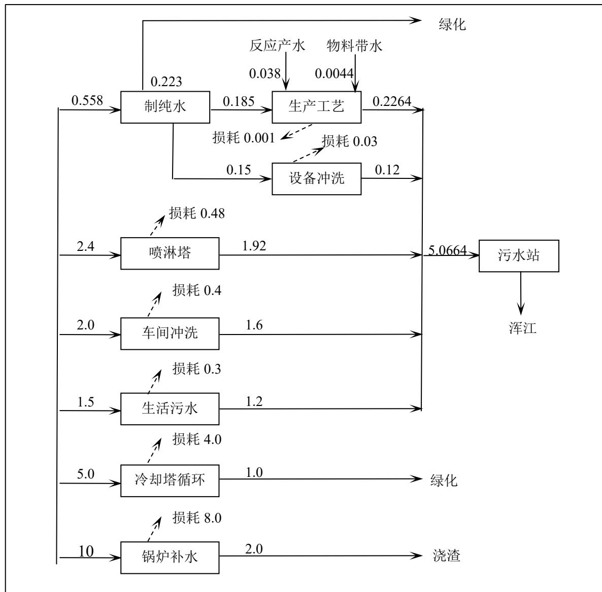
图 2-4 本项目给排水平衡图 单位:  $\text{m}^3/\text{d}$
