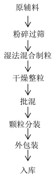
图 3-5 颗粒剂工艺流程示意图
