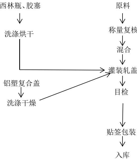
图 3-5 无菌粉针剂生产工艺流程示意图
