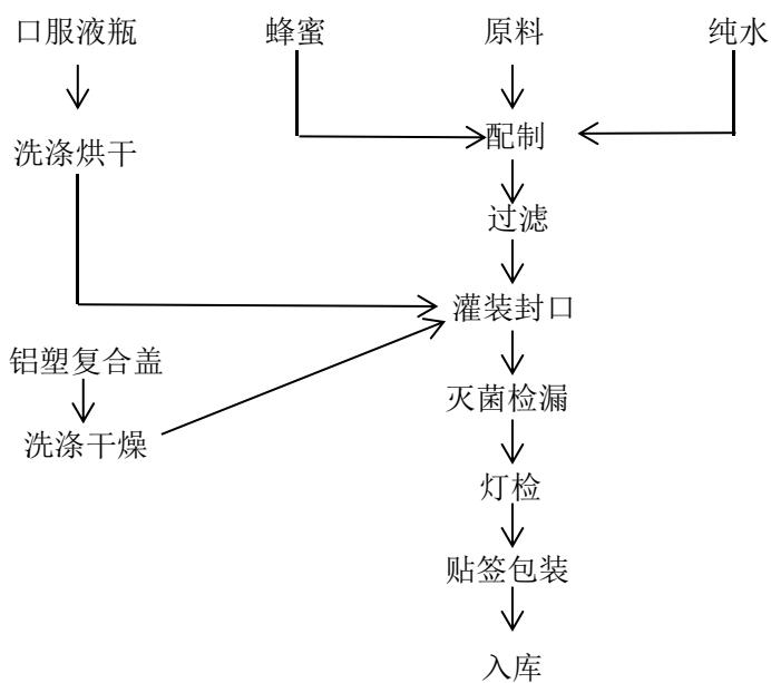
图 3-5 直口瓶口服液生产工艺流程示意图
