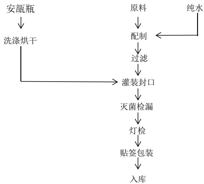
图 3-5 安瓿水针剂生产工艺流程示意图
