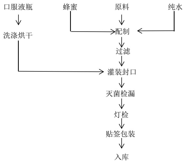
图 3-5 曲颈瓶口服液生产工艺流程示意图
