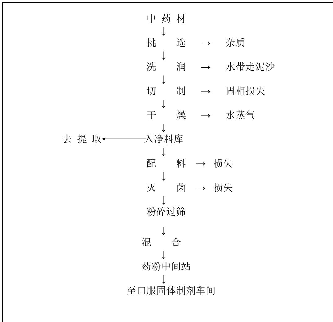
图 3-4 前处理工艺流程示意图
