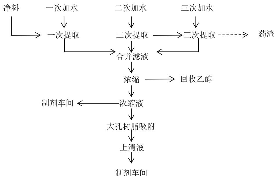
图 3-5 醇提工艺流程示意图
