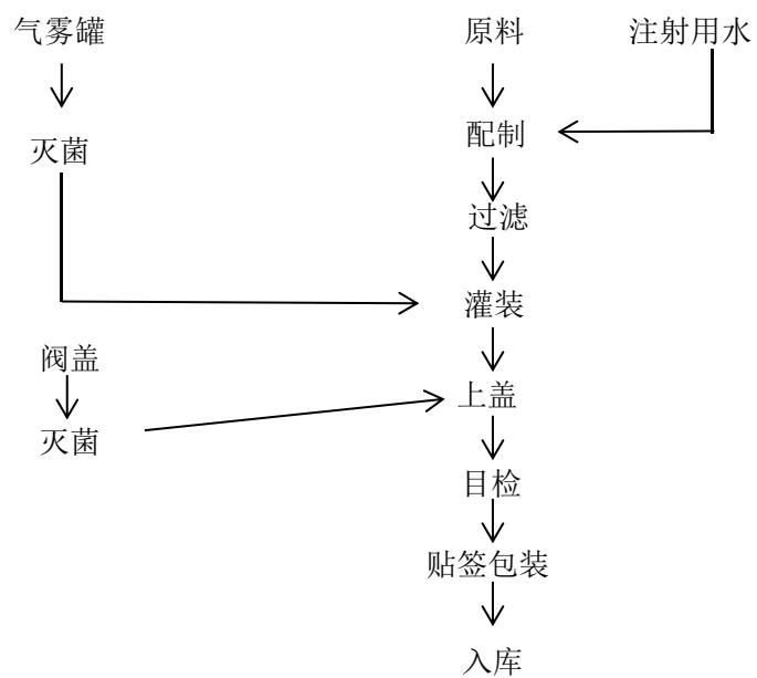
图 3-5 气雾剂生产工艺流程示意图
