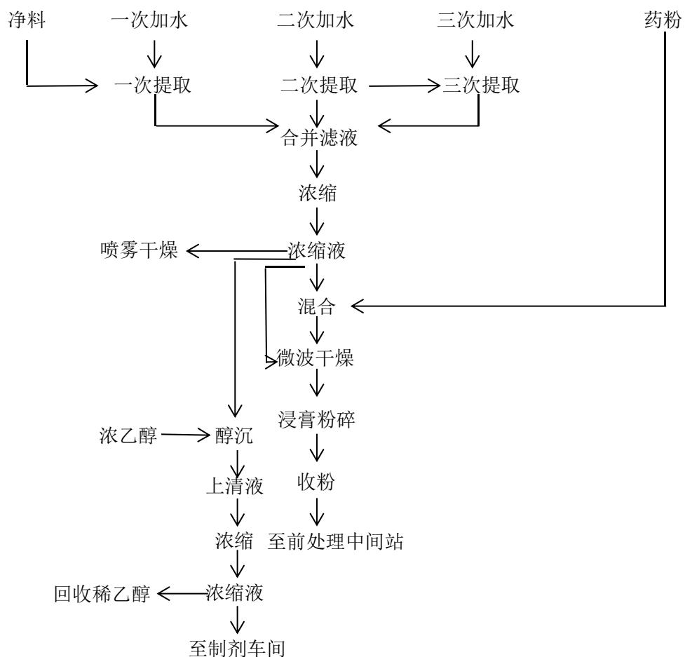
图 3-5 水提工艺流程示意图
